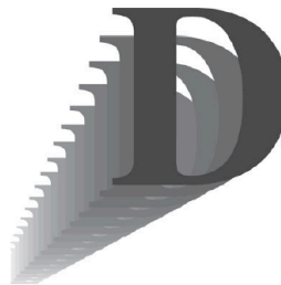
Abb. 6.5. Skalierung: der Buchstabe D wird mehrfach skaliert; nach jedem Schritt wurde zusätzlich eine Translation angewendet.
