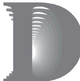
Abb. 6.4. Skalierung: der Buchstabe D wird mehrfach skaliert; der Ursprung liegt im Mittelpunkt.
